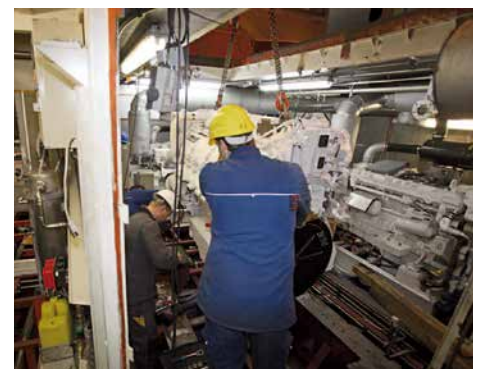
Einbau des 3.5 Tonnen Caterpillar Motors
