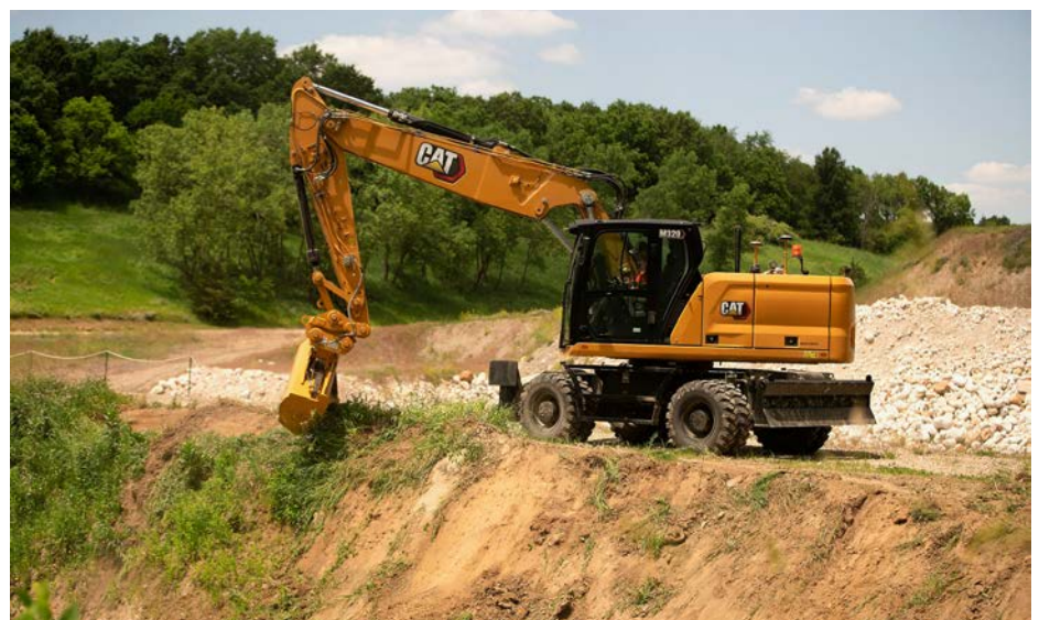
Der Mobilbagger Cat M320 ist sehr wendig und lässt sich mit unterschiedlichen Anbaugeräten sehr vielseitig einsetzen.
