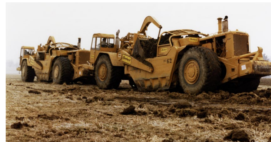
Doppelmotor-Scraper sind mehrheitlich für den Push-Pull-Betrieb ausgerüstet.
