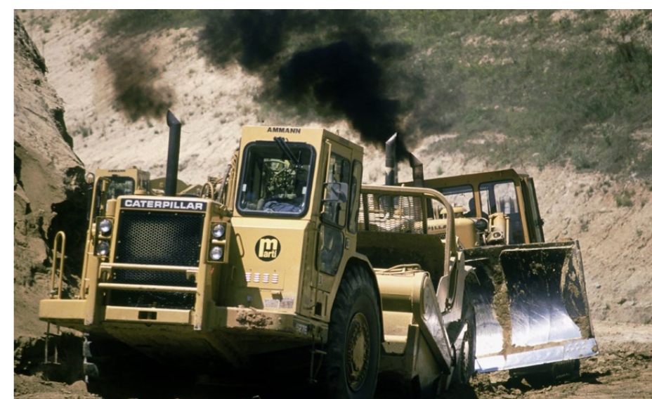
Scraper werden beim Schürfen oft durch eine Schubdraupe unterstützt.
