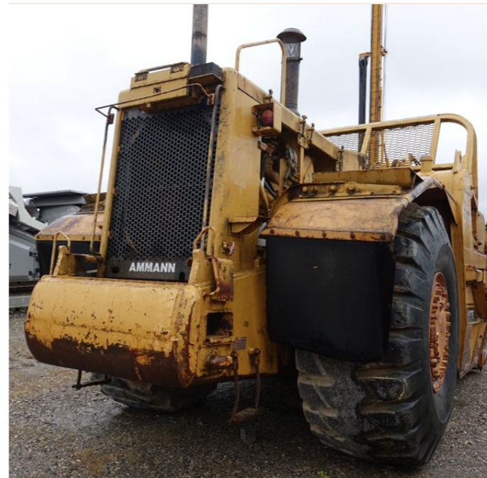
Die Zugmaschine des Scrapers wird als Traktor bezeichnet. Die schwere Maschine erreicht bis zu 57 Stundenkilometer. Das Material kann bis zu fünf Kilometer Distanz befördert werden.
