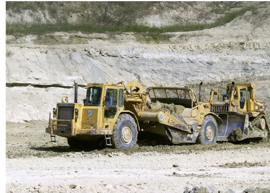
Ein Scraper CAT 436 von Marti im Einsatz in einer Grube zwischen Gletterens und Vallon.
