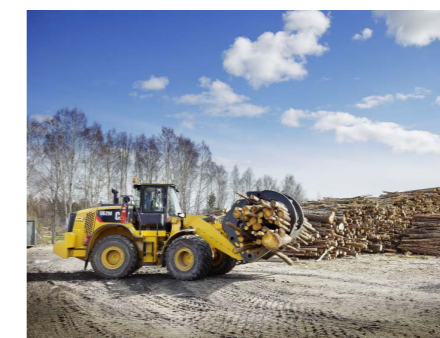
Auch die Radlader 950M (links) und 962M (Mitte und rechts) haben einen Cat-Motor, der die Emissionsnormen Stufe IV einhält, und sie bieten mehr Leistung als ihre Vorgänger. Dank dem Cat-Wägesystem können die Fahrer dieser sehr vielfältigen Maschinen zudem zuverlässig genaue Lasten erzielen.
