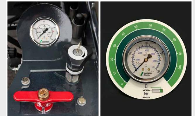
Mit VarioPressure kann der maximale Förderdruck über einen Drehgriff manuell eingestellt werden, um zum Beispiel Schlauchleitungen mit geringerem zulässigen Betriebsdruck vor zu hohen Förderdrücken zu schützen.
