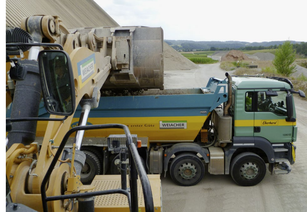
Der Cat 988K XE beim Beladen des Transporters. Das interne Waagsystem verhindert eine Überladung.
