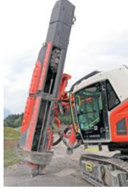
Bei den Modellen der Ranger DXi-Familie ist der Silencer in geschlossener Form fix verbaut. Zwei Öffnungen ermöglichen die optische Kontrolle der Bohrprozesse.
