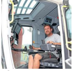
Über die beiden Joysticks und weitere Bedienelemente stehen Bohrist Thomas Watzenegger in der neuen Sandvik iCab über 30 Funktionen zur Verfügung.
