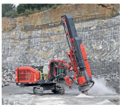
Oberwagen des Ranger DX800i Silencer können aus einer Geräteposition mehrere Bohrlöcher in einem Arbeitsradius von 290° gebohrt werden. Der exakte Winkel für die Bohrungen wird über die GPS-Antennen sichergestellt.
