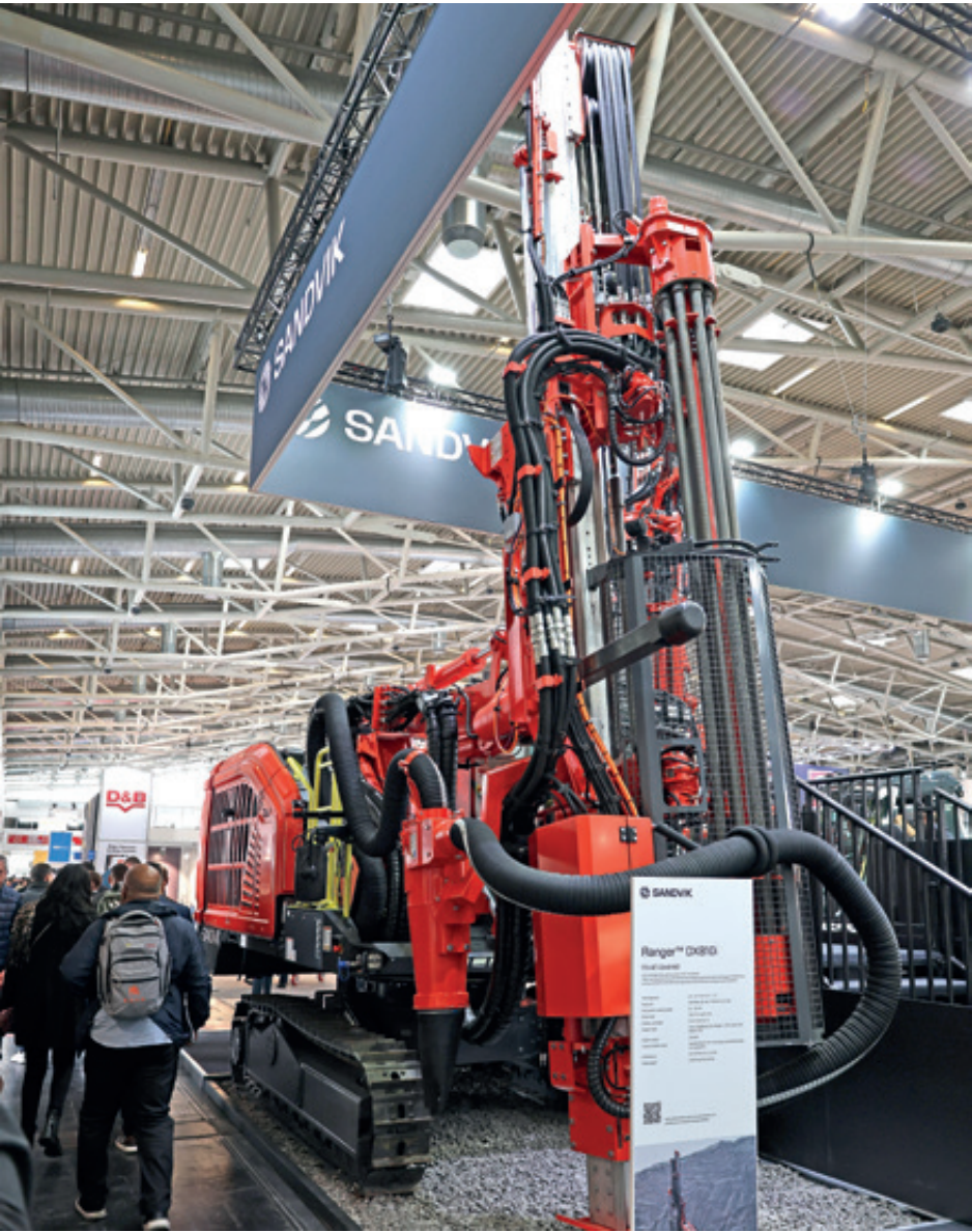
Sandvik Neuheit auf der bauma: Der Ranger DX810i ist ein hydraulisches, selbstfahrendes und auf einem Raupenfahrwerk montiertes Übertagebohrgerät. Das Bohrgerät verfügt über intelligente Optionen von Sandvik, leistungsstarke RD900-Bohrhämmer, zuverlässige Bohrwerkzeuge und ein optimiertes Bohrsystem mit einem Bohrradius von 290°.
